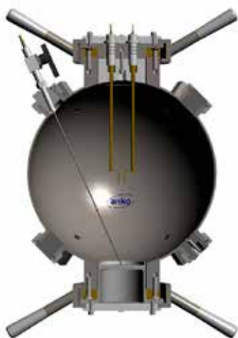
Rys. 1. Stanowisko do badania granic wybuchowości cieczy palnych
