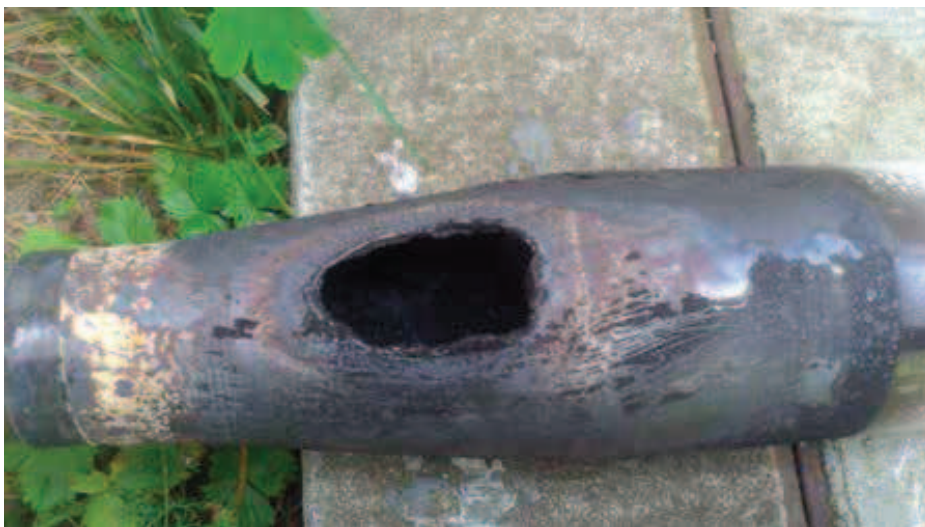
Rys. 1. Efekt przepalenia metalowego korpusu silnika raketowego
