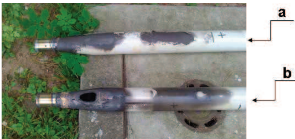
Rys. 2. Korpusy silnika raketowego po stacjonarnym badaniu balistycznym: a) z modernizowaną termoizolacją, b) z termoizolacją stosowaną do wyrobu GROM
