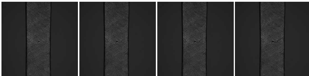
Rys. 8. Zarejestrowane obrazy prezentujące kolejne fazy pęknięcia próbki
