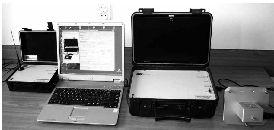
Rys. 3. Kopalniana Stacja Monitoringu Drgań (KSMD) – widok ogólny
