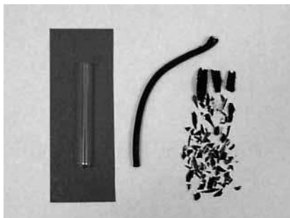
Rys. 2. Skutki próby zapłonu lontem prochowym 0,2 g mieszaniny fotobłyskowej. Na lewo – próbka przed badaniem; w środku – lont prochowy; na prawo – fragmenty próbówki po badaniu. Badanie własne.
