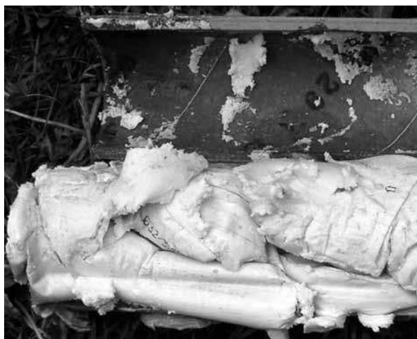
Rys. 3. Widok załadowanego pneumatycznie otworu strzałowego Emulinitem PM.
