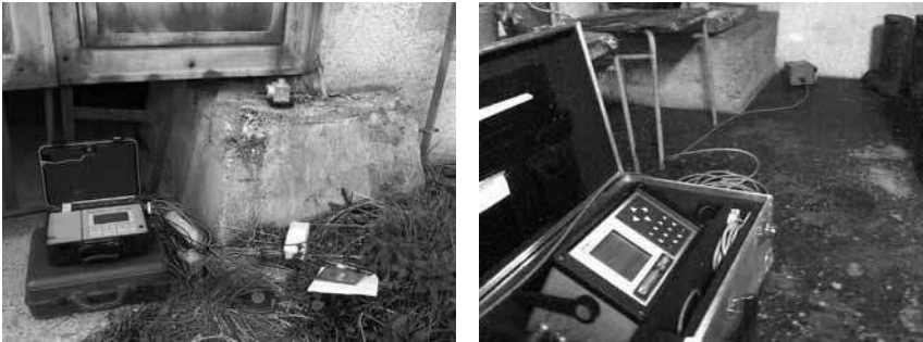
Obr. 8. Stanovisko č. 6 (senník JRD) - seizmograf UVS 1504 a seizmosnímače švédskej firmy Nitro Consult a stanovisko č. 2 (obytný dom č. 243 Výšná Šebastová) s registračnou seizmickou aparátúrou ZEB/SM-3C a seizmosnímačom firmy Orica Mining Services, SRN.
