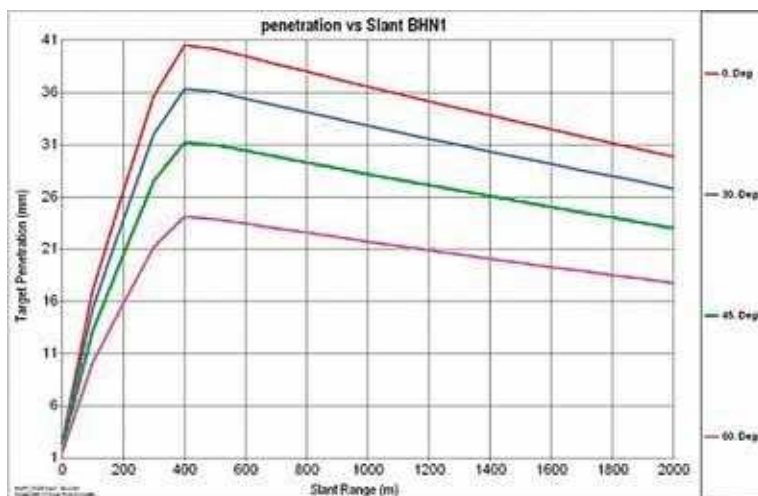
Rys. 9. Przebijalność płyty stalowej w funkcji odległości od celu i kąta uderzenia w cel.
