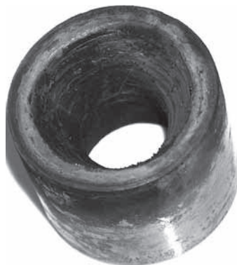
Rys. 3. Dysza z kompozytu C-C po statycznej próbie spalaniem
