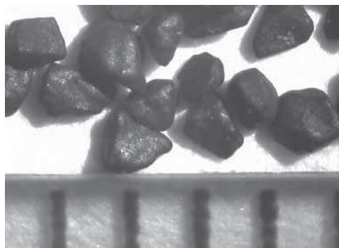
Rys. 5. Ziarna badanego prochu czarnego. Powiększenie 50×
